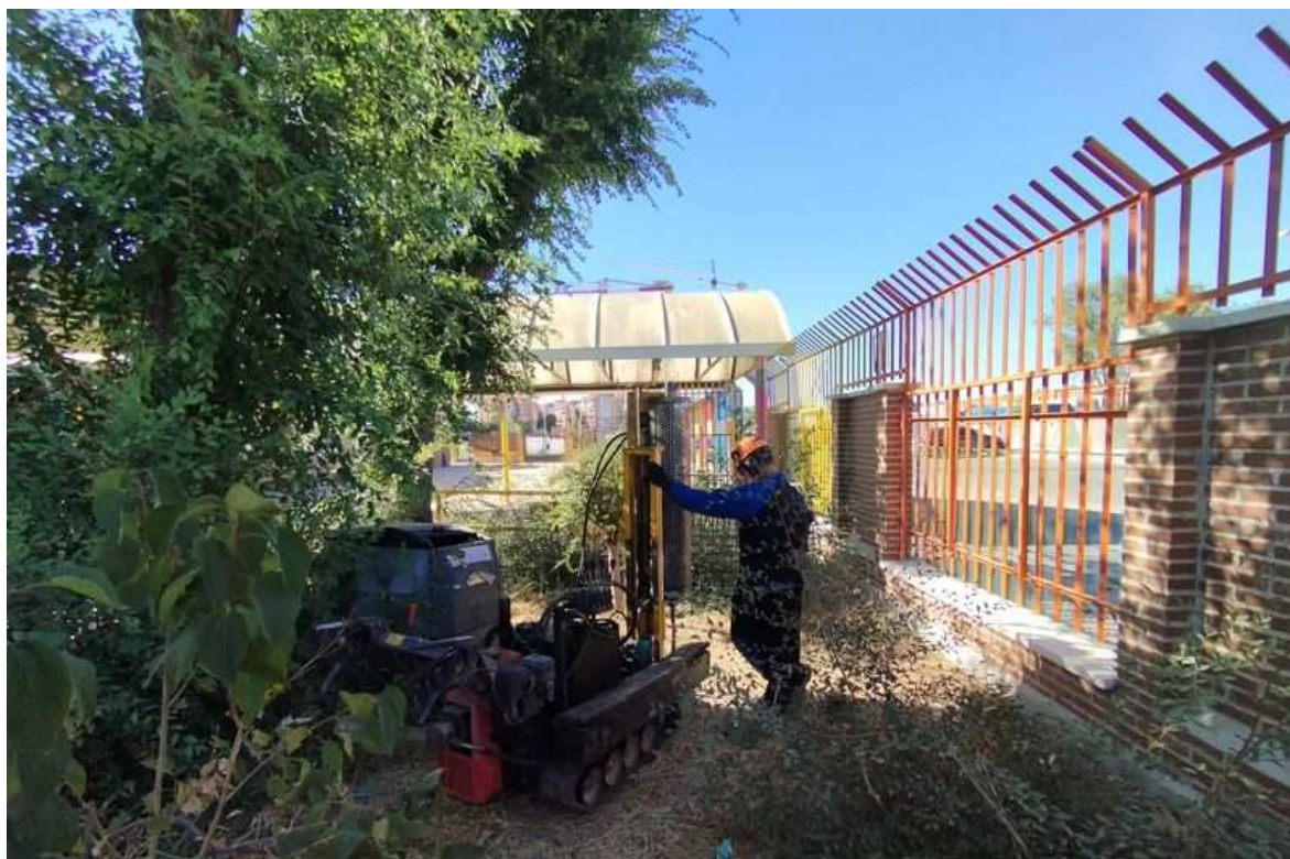
FOTOGRAFIA 7: Vista de la realización del Penetrómetro 3.
